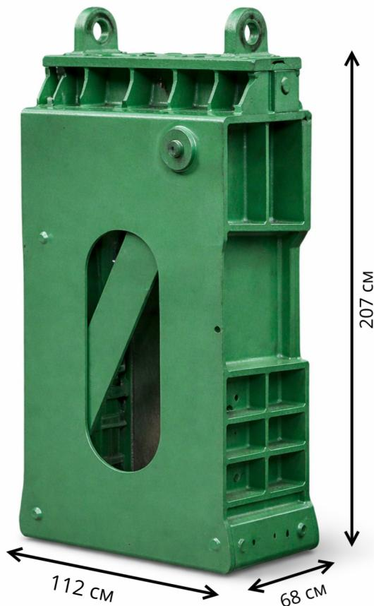
Предназначен для вибропогружения свай с учетом лидерного бурения диаметром 200-550.
